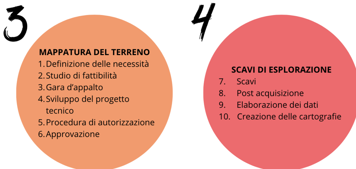
Figura 4.28: tappe consigliate da Géothermie Suisse per procedere agli scavi di esplorazione
