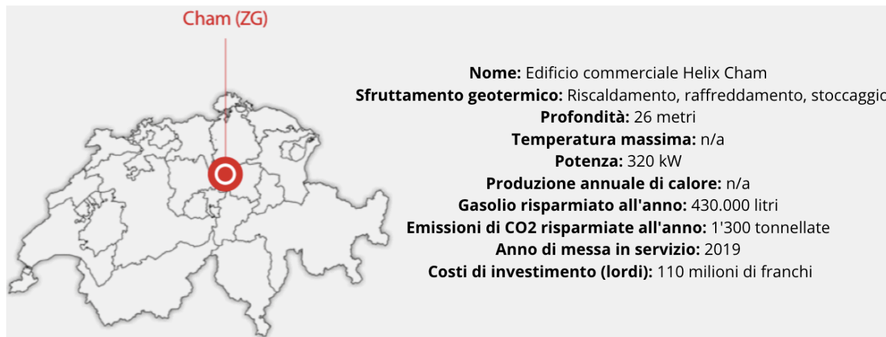
Figura 4.31: Dati, in sintesi, dell'esempio del Immobile Commerciale Helix a Cham 105
