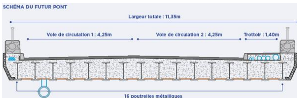
Figura n°20: Schema del futuro ponte del "Bourg-Neuf" che verrà costruito entro la fine dell'anno 2024
